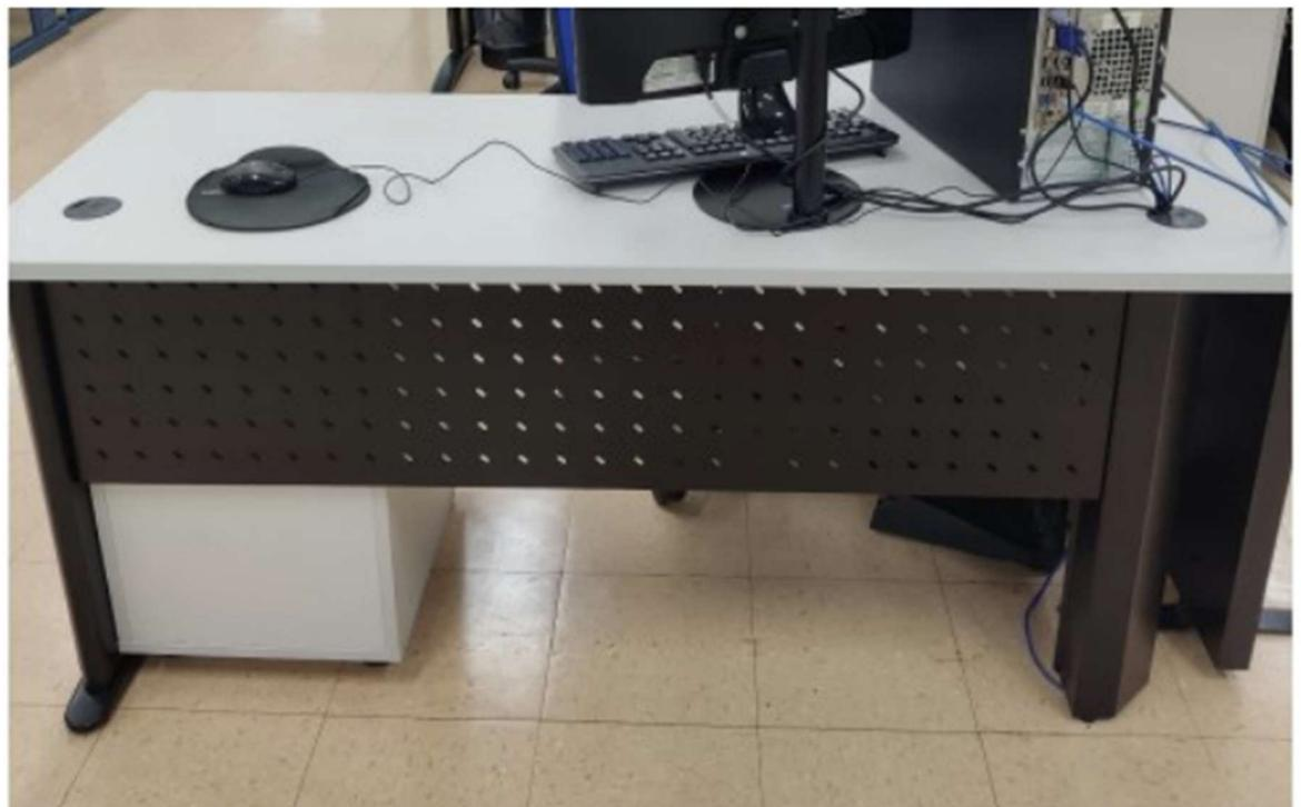
*Figura 2 - Exemplo de painel frontal metálico com perfuração estampada*
